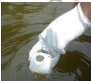
Figura 3: Amostragem de água superficial diretamente do corpo d'água.
